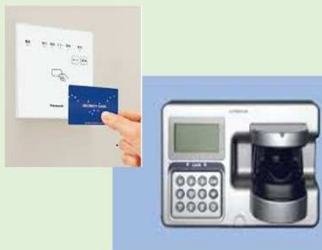
非接触ICカードと静脈認証装置によるダブルチェック
